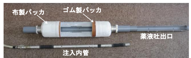
写真-1 地山パッカの構造
